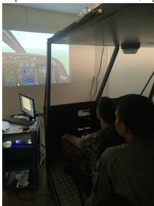
Figura 2 – Simulador de voo do tipo ATD, disponível no 4º BAvEx. (Fonte: o autor).
