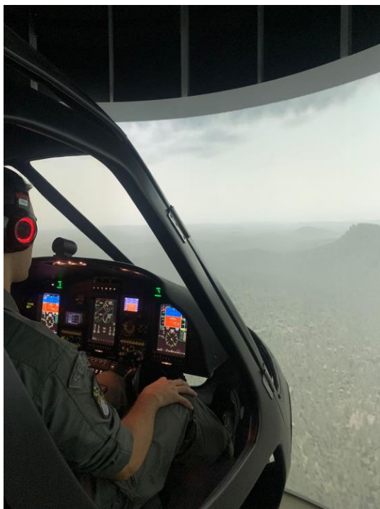
Figura 1 – Simulador de voo do tipo FTD da aeronave H-125M Fennec, disponível no CIAvEx. (Fonte: o autor).
