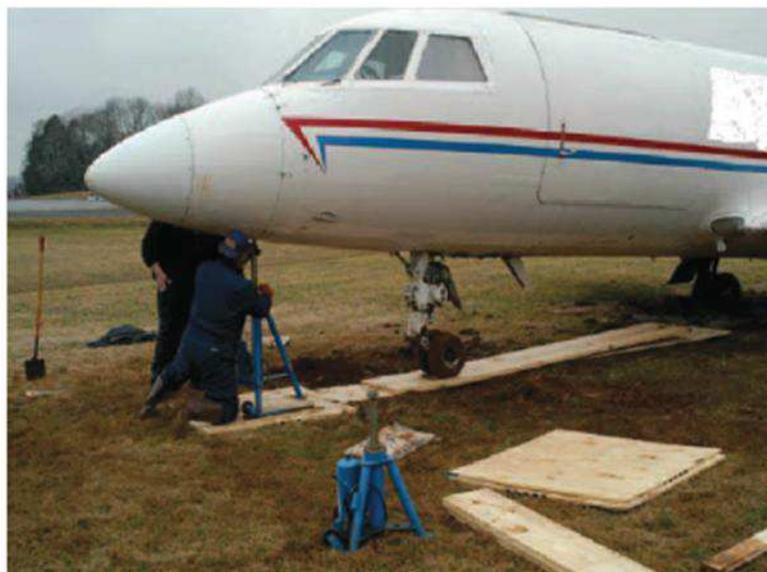
**Figura 8:** Elevação utilizando equipamento hidráulico.
