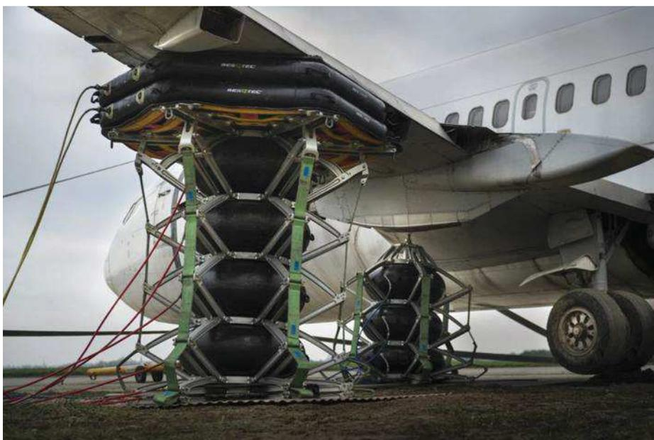
**Figura 9:** Elevação utilizando equipamento pneumático
