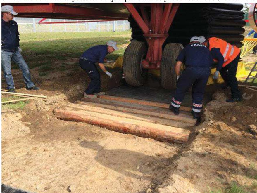
**Figura 12** - Procedimento para retirar aeronave em situação Debagging
