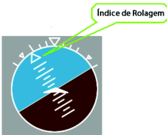
Figura 9: Indicador de Atitude em grandes aeronaves comerciais Fonte: Adaptado de Singer e Dekker (2002)
