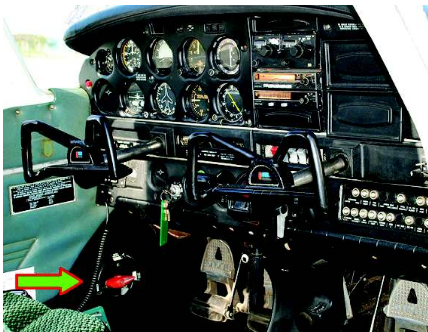
Figura 05: Localização do controle da válvula seletora de combustível em uma aeronave Piper 28 (Arrow III) Fonte: Autores
