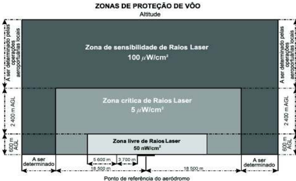
FIGURA 4 – Zonas de Proteção de Voo com os Níveis Máximos de Irradiações para Raios LASER Visíveis (ANAC, RBAC 154).
