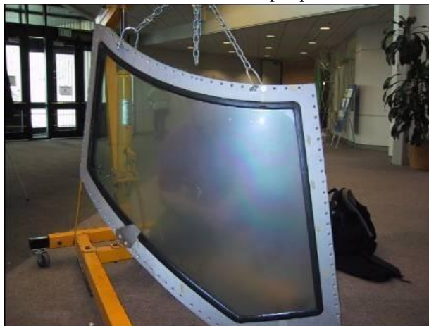
Figura 4 - Janela de cockpit erodida durante o voo por partícula de cinza (SERVRANCKX, 2016).
