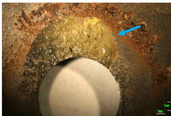
Figura 5: Região do orifício de fixação da arruela e parafuso.
