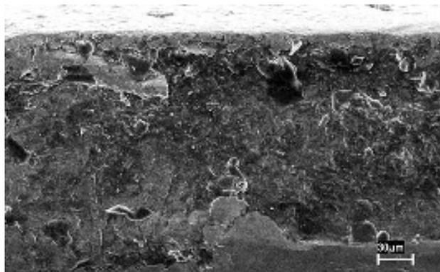
Figura 8: Superfície de fratura – detalhe da região de pré-trinca da **Erro! Fonte de referência não encontrada.**
