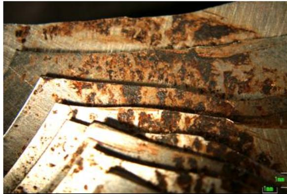
Figura 3: Sequência de lâminas, região das fraturas com corrosão e contaminação em todas as lâminas.
