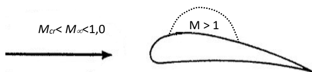
Figura 6- Bolha Supersônica no Escoamento Transônico.
