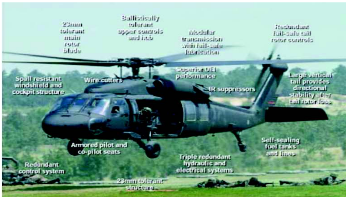
FIGURA 01 - Design for survivability (projeto de sobrevivência) de helicóptero implementadas no projeto (VELÁSQUEZ, 2008)
